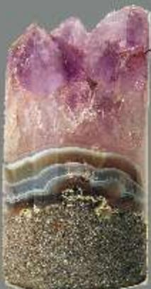
Testemunho de furo em geodo, mostrando basalto, ágata, quartzo e ametista
